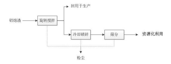
图 2.8-5 配套铝渣回收利用工艺流程及产污节点图
