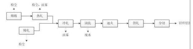
图 2.8-1 钎焊铝箔工艺流程及产污节点图
