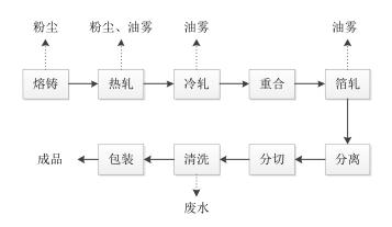
图 2.8-4 电池单面光集电体工艺流程及产污节点图
