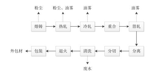
图 2.8-2 电池外包材工艺流程及产污节点图
